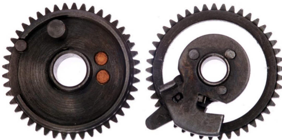
Spodní ozubené kolo 93.00 a horní čelní kolo 92.00 převodovky Pentacon Six – v tomto případě obě se 45 zuby.
